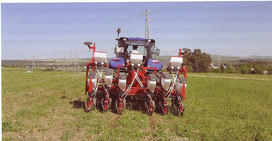
Foto 11. Sembradora monograno de precisión con tolva para semilla y abono microgranulado con tratamiento insecticida sembrando maíz.
