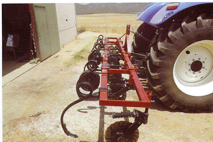
Foto 7. Apero para realizar microlabores específicos antes de la siembra directa en cultivos de primavera.
