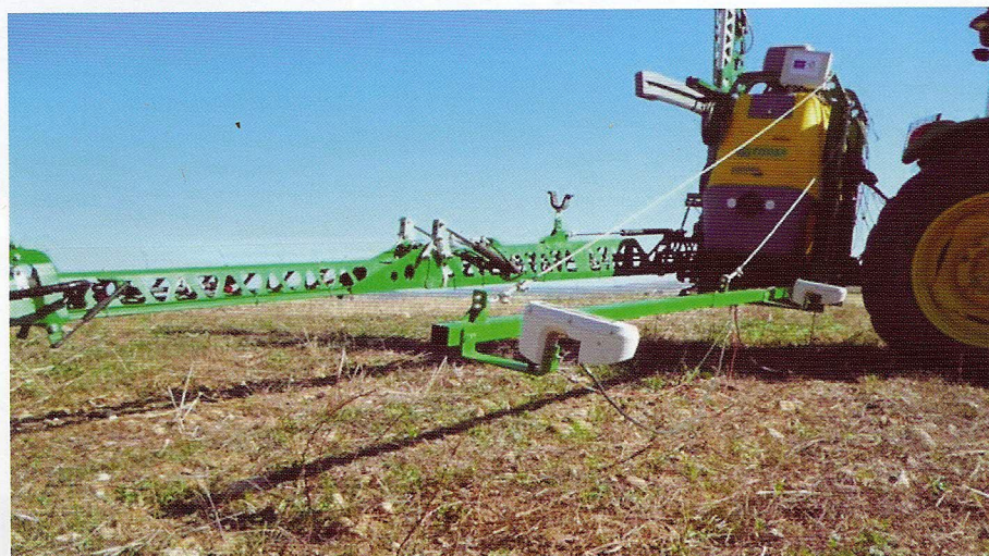
Foto 12. Barra de tratamientos con sensores de detección de hierbas.
