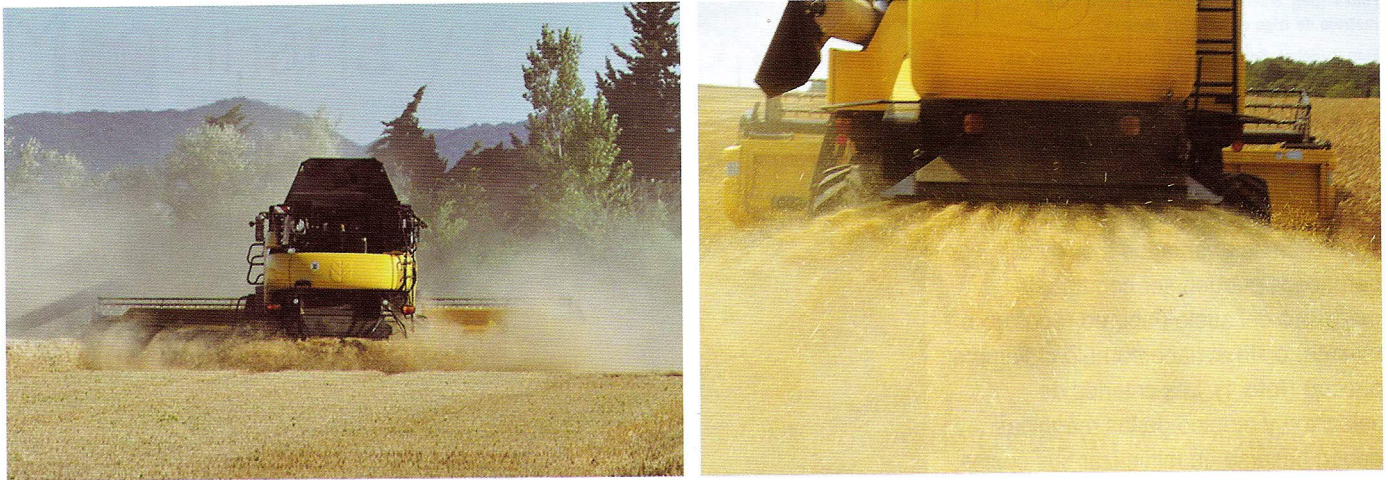
Foto 3. Cosechadora distribuyendo rastrojo en todo su ancho de trabajo (izquierda) y detalle del sistema de distribución (derecha).
