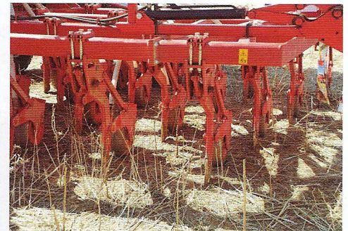
Foto 9. Sembradora directa de reja con cuatro líneas de cuerpos para permitir el flujo de restos entre los mismos.
