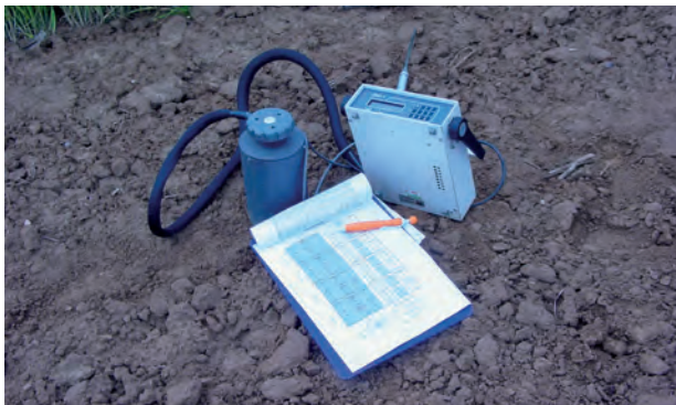
Figura 4. Medidor EGM2000 utilizado en el estudio. En la imagen se aprecia la cámara de captación del gas, el lector LCD y el termómetro de campo.
